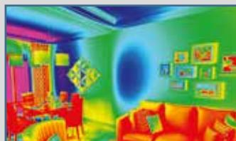
Termal görüntüleme ile yalıtım sorunlarını ve ısı kaçak noktalarını tespit ediyoruz.
